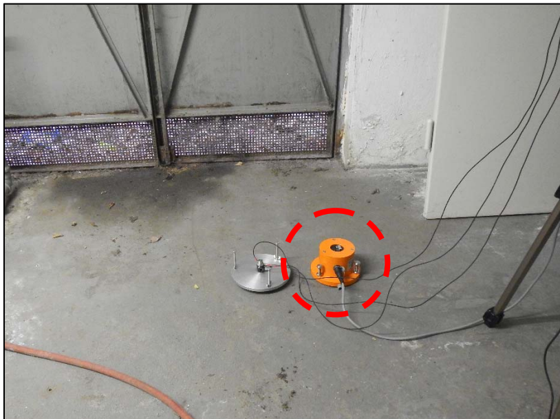
Abbildung 5: Messaufbau mit 3D-Seismometer
