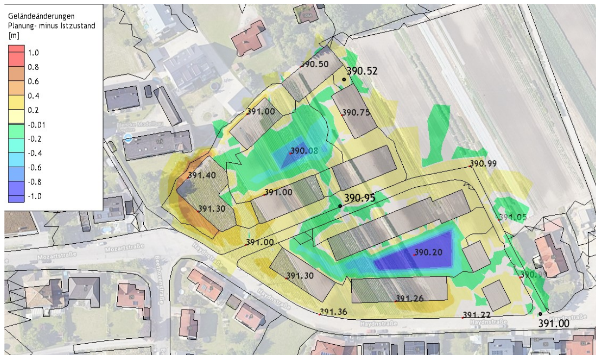
Abbildung 5.1: Geländeunterschiede des Planungszustandes zum Istzustand (gelb/orange = Geländeanhebungen, grün/blau = Geländeabgrabungen), Geländehöhen in müNNH in DHHN16
